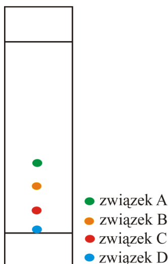
Rysunek 30. Analiza TLC mieszaniny zawierającej związki: A, B, C i D przy zastosowaniu fazy ruchomej: heksan-eter diizopropylowy (3:1, v/v) [na podstawie Laboratory Chromatography Guide . Talamona, 2005]
