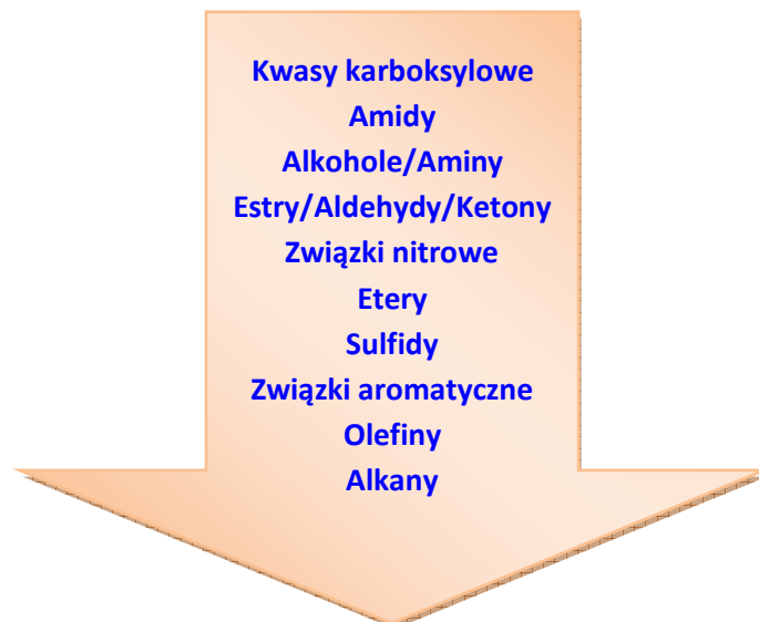
Rysunek 24. Kolejność elucji związków z żelu krzemionkowego [na podstawie Laboratory Chromatography Guide . Talamona, 2005]
